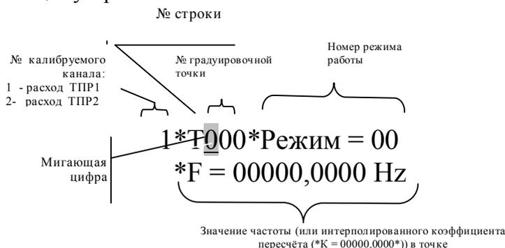
При этом звуковой сигнал отключается и мигает цифра показывающего устройства, которая в данный момент может быть изменена. При нажатии вводимой цифры, начинает мигать следующая по порядку цифра.
